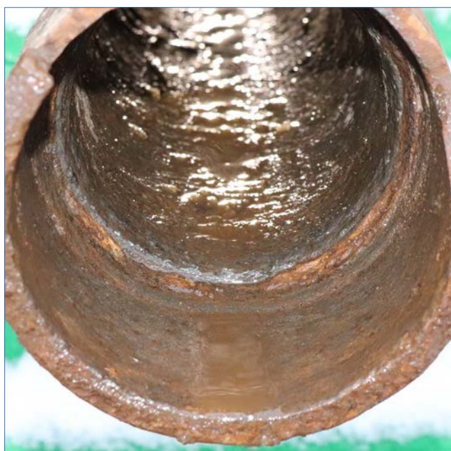
Rúrky je potrebné prepláchnuť vodou a zároveň čistenie.
