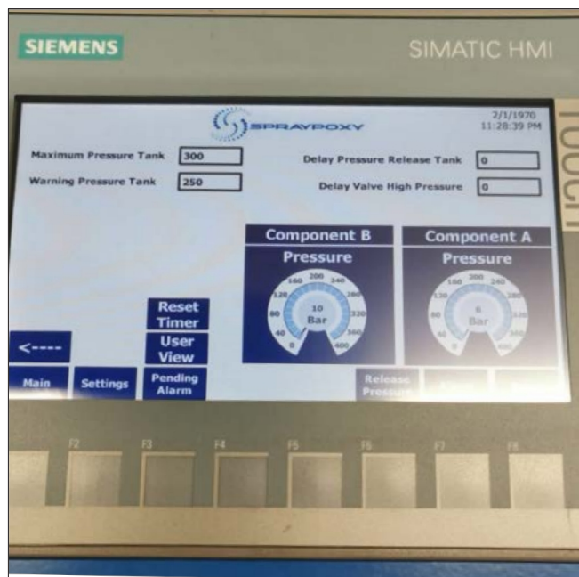
9. Čerpadlo je pod tlakom a je pripravené na prácu.
